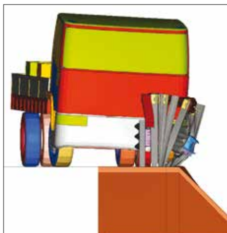
7. La simulazione del crash test con il terreno del campo prove
