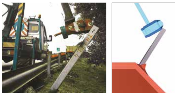
8A e 8B. La calibrazione del terreno in situ mediante prove dinamiche e simulazioni
