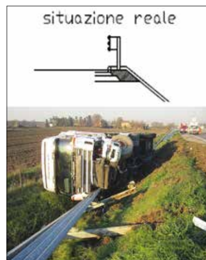
2A e 2B. Il comportamento di una barriera in caso di impatto nel campo prove (2A) e in situ (2B)
