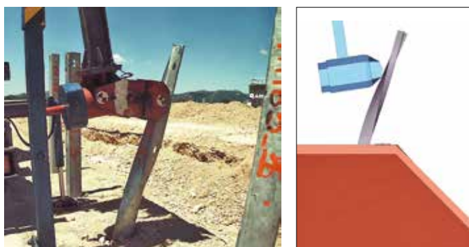
6A e 6B. La calibrazione del terreno del campo prove mediante prove dinamiche e simulazioni
