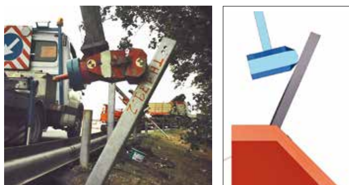
10A e 10B. La calibrazione del terreno in situ con S.C.Re.W.S. mediante prove dinamiche e simulazioni
