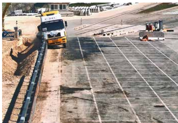
5. Un crash test sulla barriera oggetto dell'intervento
