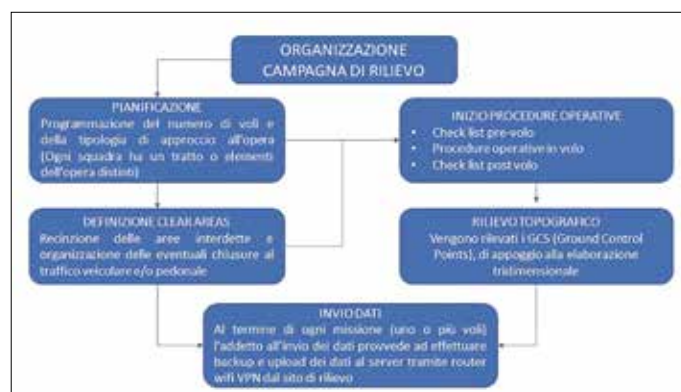
3A, 3B e 3C. La schematizzazione della metodologia di ispezione
